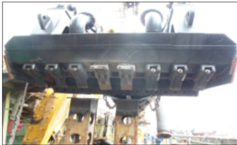
图 4.1-7 最新挖掘型耙头及不同类型的耙齿
