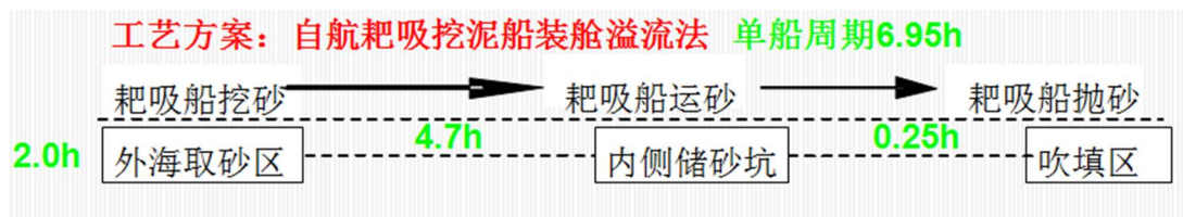
图 4.1-4 耙吸挖泥船挖泥运转周期示意图
