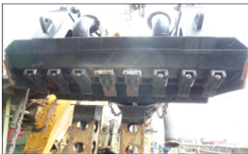
图 4.1-7 最新挖掘型耙头及不同类型的耙齿
