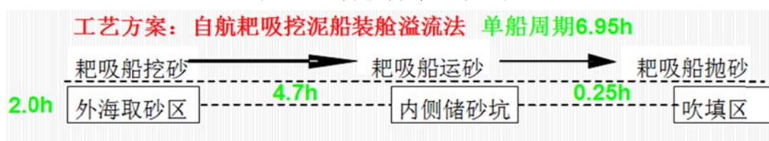
图 4.1-4 耙吸挖泥船挖泥运转周期示意图
